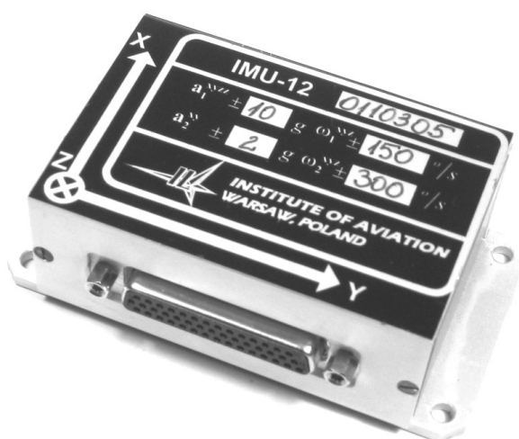
Rys. 7. Podwójnie rezerwowany blok inercyjnych czujników pomiarowych IMU-12 – wygląd zewnętrzny
