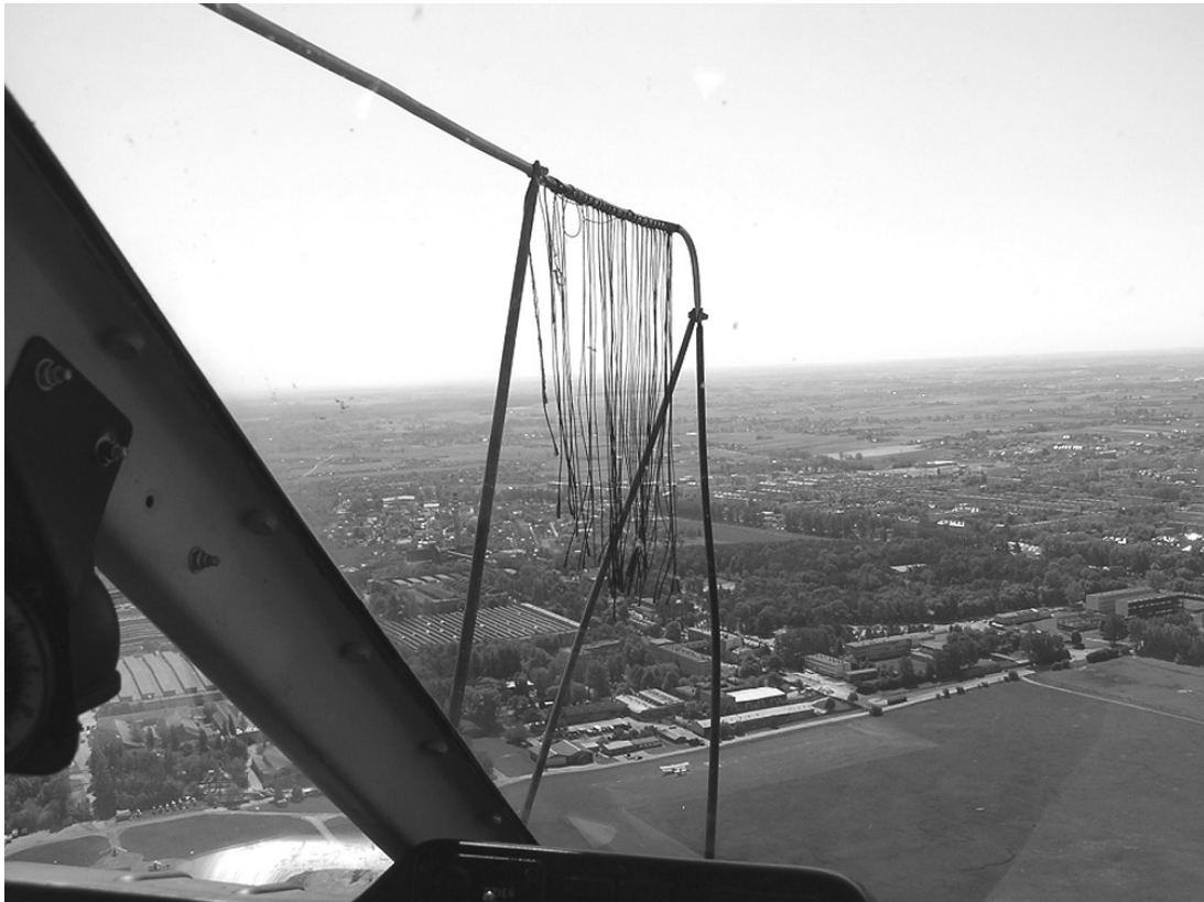
Rys. 17. Specjalny wskaźnik prędkości zerowej śmigłowca względem otaczającego powietrza tuż przed imitacją awarii silnika w zawisie na wysokości h = 222\text{ m}
