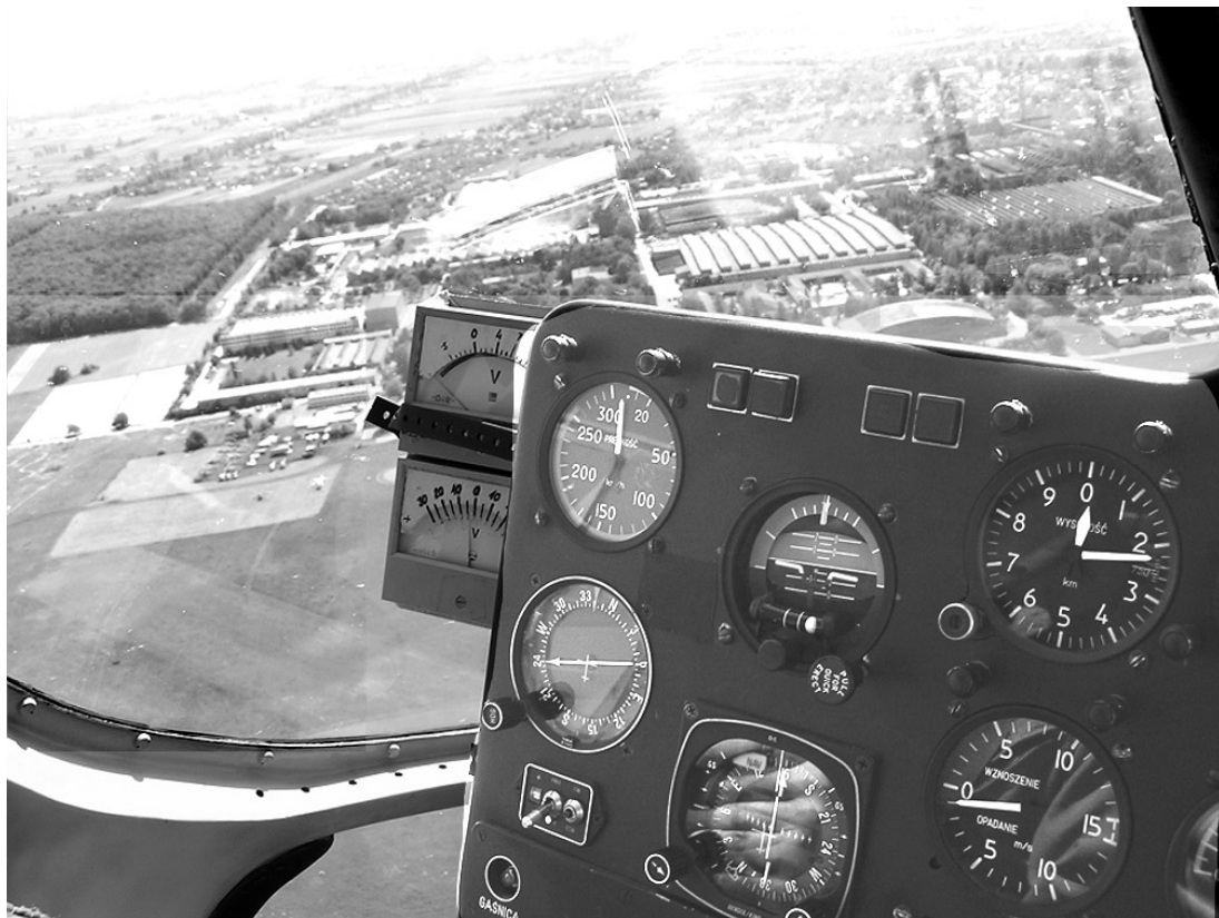
Rys. 18. Wskazania przyrządów pokładowych tuż przed imitacją awarii silnika w zawisie na wysokości h = 222\text{ m}
