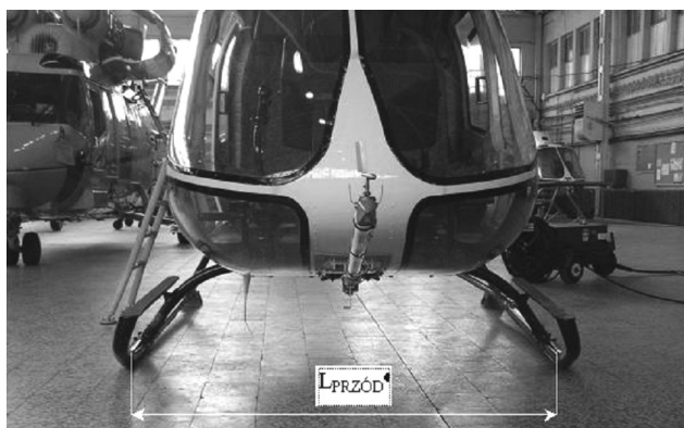
Rys. 2. Miejsca kontroli rozstawu płóz podwozia (z tyłu i z przodu)
