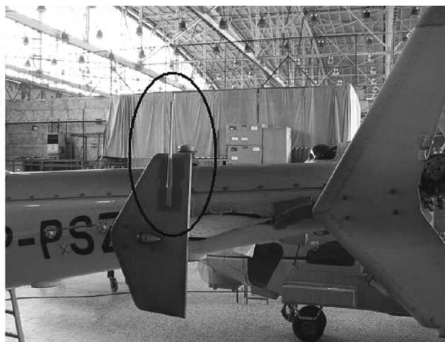
Rys. 3. Sposób mocowania pałeczki z balsy na lewym stateczniku pionowym
