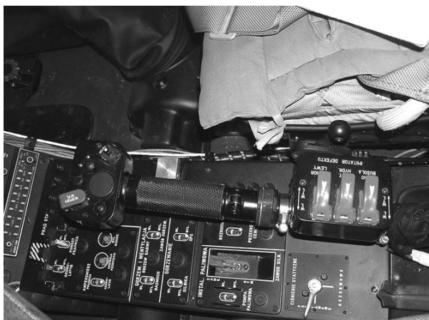
Rys. 4. Wyposażenie kabiny śmigłowca do lotów bez widoczności ziemi
