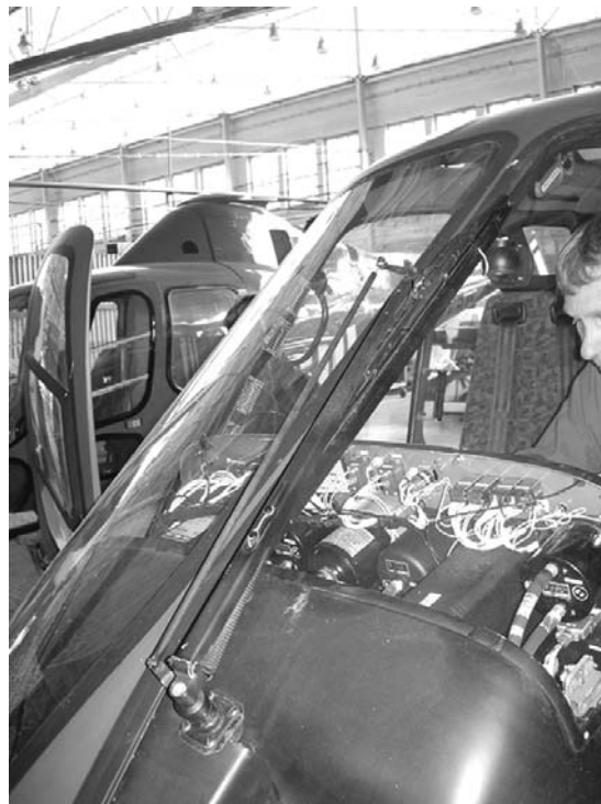
Rys. 5. Zabudowa wycieraczki na przedniej szybie
