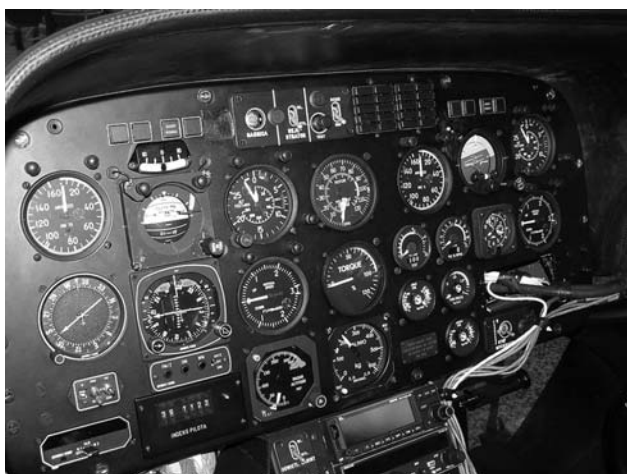
Rys. 2. Tablica przyrządów śmigłowca
