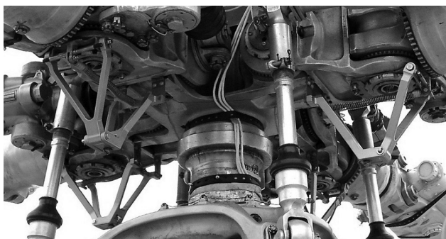
Fot. 3. Komplet ograniczników zwisu łopat wirnika nośnego na śmigłowcu
