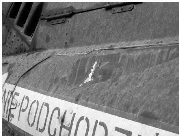
Fot. 1. Uszkodzenie belki ogonowej śmigłowca W-3 na skutek uderzenia łopaty wirnika nośnego w trakcie rozruchu wirnika
