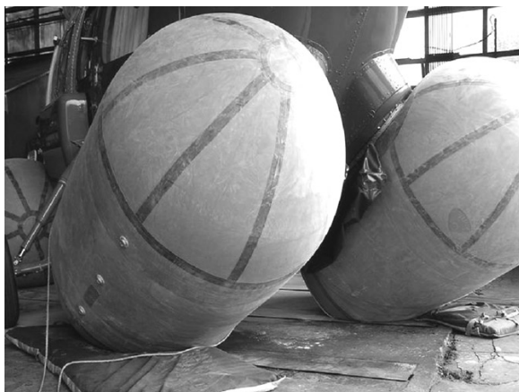
Fot. 13, 14. Śmigłowiec z napelnionymi pływakami, widok z przodu i z tyłu
