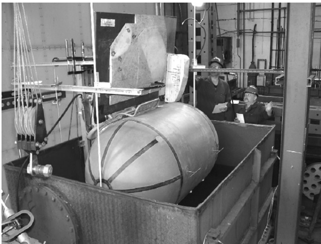
Fot. 8+11. Próby węzłów kadłubowych mocowania pływaka PG-1300B
