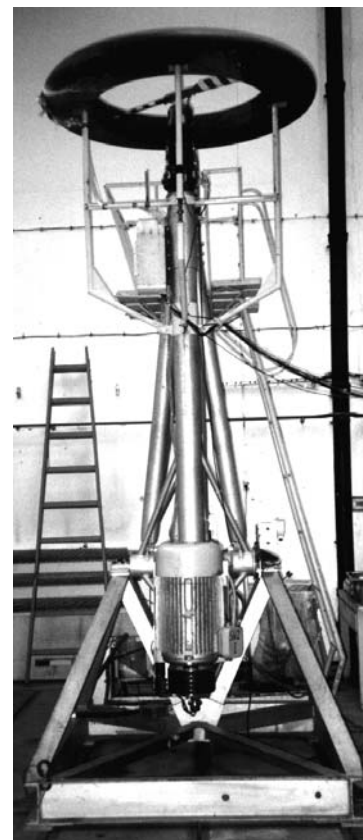
Rys. 16. Badania modelu wirnika nośnego śmigłowca IS-2 na stoisku śmigłowcowym w tunelu aerodynamicznym T-3
