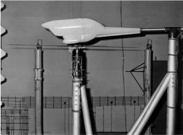
Rys. 12. Modelowe badania śmigłowca PZL Sokół z pracującym wirnikiem nośnym w tunelu T-3
