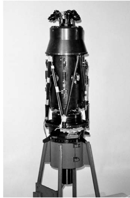
Rys. 4. Urządzenie pomiarowo-sterujące PS do symulacji sterowania modelem wirnika nośnego
