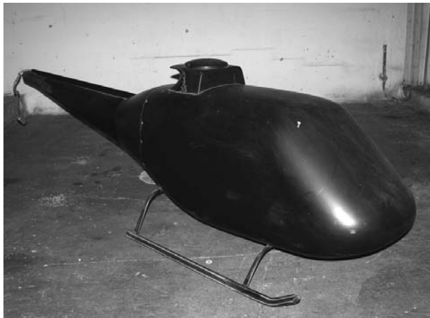
Rys. 13. Model kadłuba śmigłowca SW-4 PZL Świdnik do badań na stoisku śmigłowcowym w tunelu T-3
