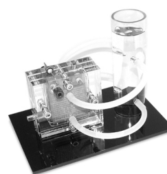
Fig. 4. The double -cell PEM electrolyzer Rys. 4. Dwu-ogniwowy elektrolizer PEM
