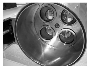
Rys. 5. Widok zespołów detekcyjnych pirometru od strony soczewek obiektywów
