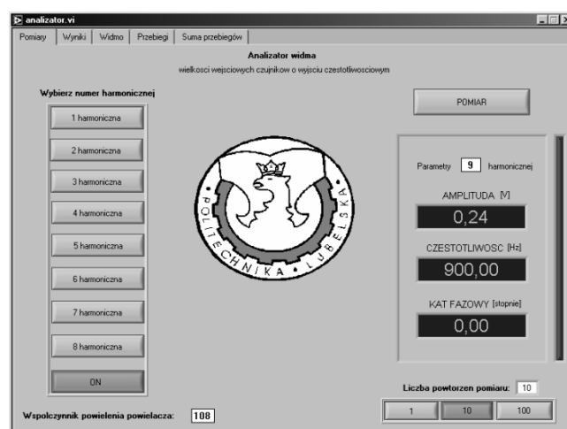
Rys. 5. Wirtualny panel czołowy analizatora Fig. 5. Virtual front panel of the analyzer
