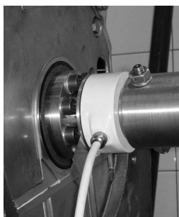
Rys. 7. Enkoder osadzony na wale silnika spalinowego Fig. 7. Encoder mounted on engine shaft
