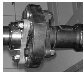
Rys. 6. Pojedynczy przegub wału łączącego silnik spalinowy z odbiornikiem mocy o takiej samej podatności jak wał stalowy o długości 100 m i średnicy 50 mm Fig. 6. Individual joint of engine – to – power receiver shaft of the same flexibility as the steel shaft of 100 m length and 50 mm diameter
