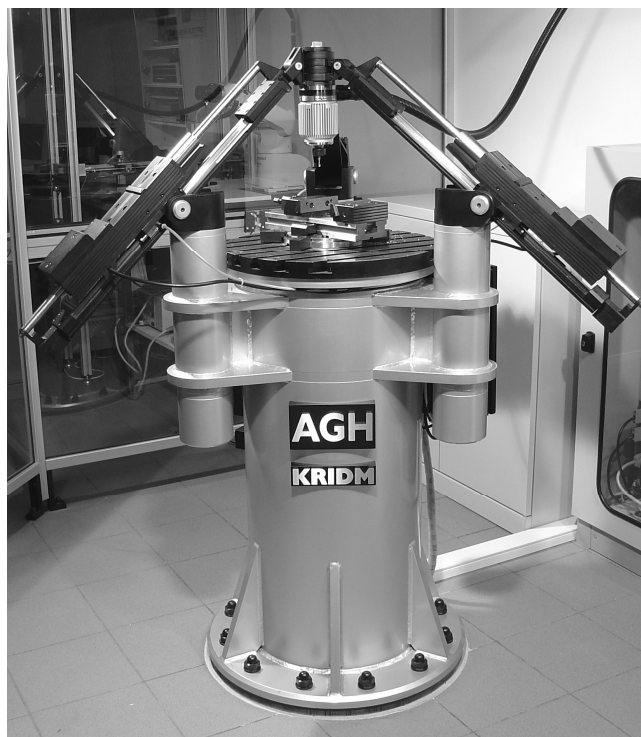
Rys. 1. Opracowany manipulator równoległy do frezowania o trzech stopniach swobody
