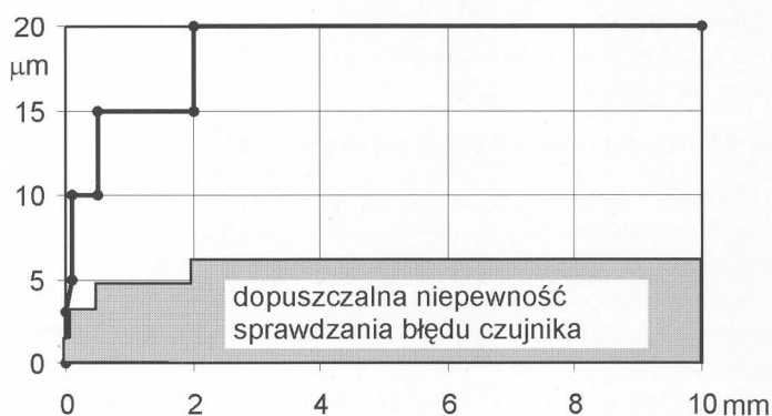
Rys. 1. Dopuszczalny błąd sprawdzania błędów wskazań czujnika zegarowego na tle dopuszczalnych błędów czujnika kl. I (wg PN 68/M 53260) w funkcji wykorzystywanej części zakresu pomiarowego.
