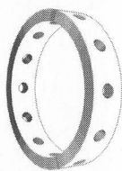
Rys. 2. Pierwsza wersja rdzenia przetwornika prądu stałego Fig. 2. The first version core of the DC transducer
