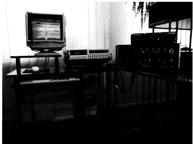
Rys. 1. Stanowisko pomiarowe do automatycznej kalibracji kalibratorów Z-183 Fig. 1. Measuring installation for automated calibration of Z-183 calibrators
