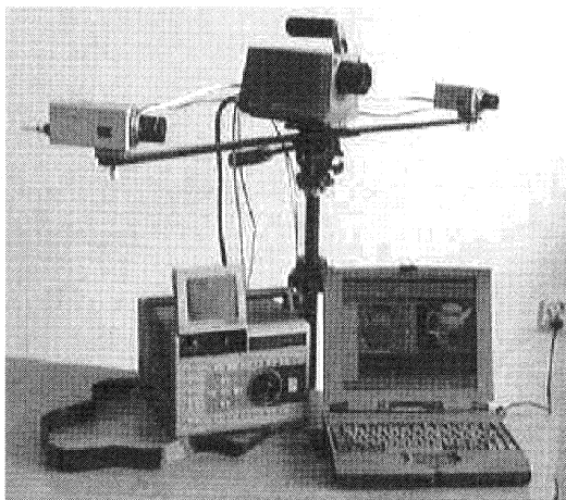
Rys. 20. System termiczno-optyczny do badań cieplnych opracowany w Zespole Termografii Komputerowej
