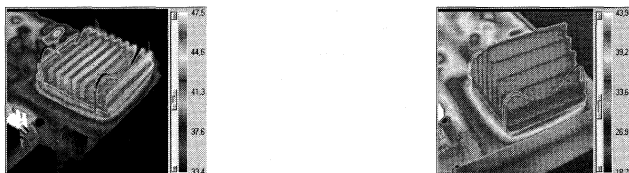
Rys. 4. Termogramy dla układu mikroprocesora Intel-486 s chłodzonego radiatorem standardowym o jednakowych żebrach ( T_{\text{max}}=47,5^\circ\text{C} ) oraz z uźebrowaniem profilowanym ( T_{\text{max}}=41,8^\circ\text{C} ), P_1=1,2\text{W}
