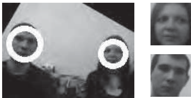
Rys. 11. Wynik działania klasyfikatora Haara
