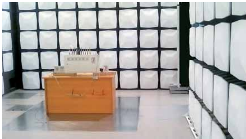
Rys. 6. Stanowisko badań (w komorze semibezodbiciowej)
