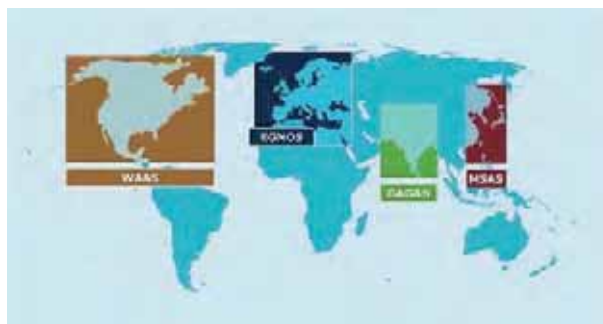
Rys. 1. Projektowane i działające systemy SBAS oraz zasięg ich działania
