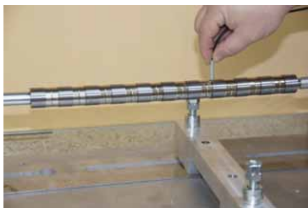
Fig. 16. The measurement of magnetic flux density Rys. 16. Pomiar indukcji magnetycznej
