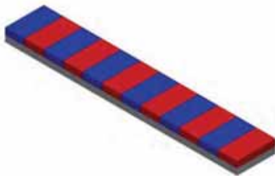
Fig. 2. The view of runner of flat linear drive Rys. 2. Widok biegnika liniowego silnika płaskiego
