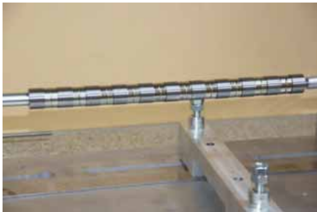
Fig. 15. The runner with interior mounted magnets Rys. 15. Biegnik z wewnątrz montowanymi magnesami
