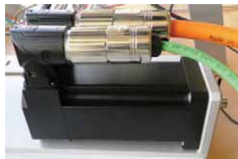
Fig. 2. Synchronous motor type PMSM used in servo valve Rys. 2. Zastosowany w zaworze silnik synchroniczny z magnesami trwałymi
