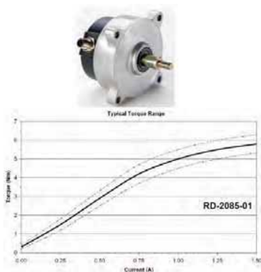
Rys. 1. Widok i charakterystyka M=f(I) hamulca RD-2085-01 Fig. 1. View and characteristic of brake RD-2085-01
