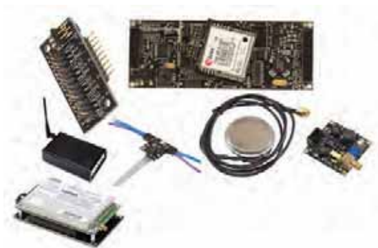
Fig. 2. Autopilot component modules
