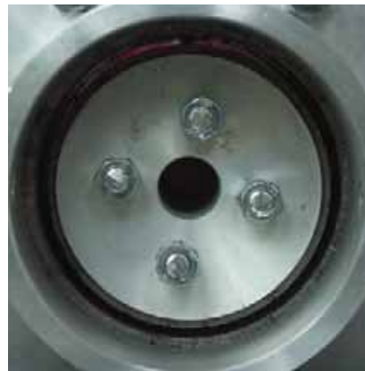
Rys. 1. Pasywne promieniowe łożysko magnetyczne opracowane i wykonane w WAT [2]
