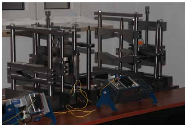
Rys. 6. Stanowisko do pomiaru charakterystyk statycznych zawiesznień magnetycznych
