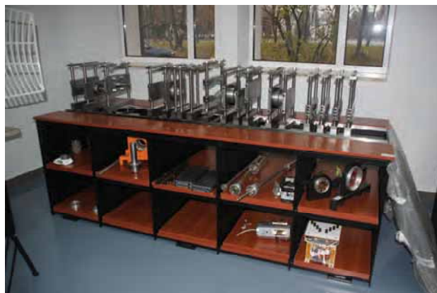
Rys. 5. Stanowisko do pomiaru charakterystyk dynamicznych zawiesznień magnetycznych
