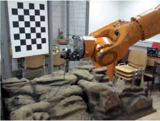
Fig. 4. Testbed for experiment with KUKA robotic arm Rys. 4. Stanowisko do eksperymentu na manipulatorze przemysłowym KUKA
