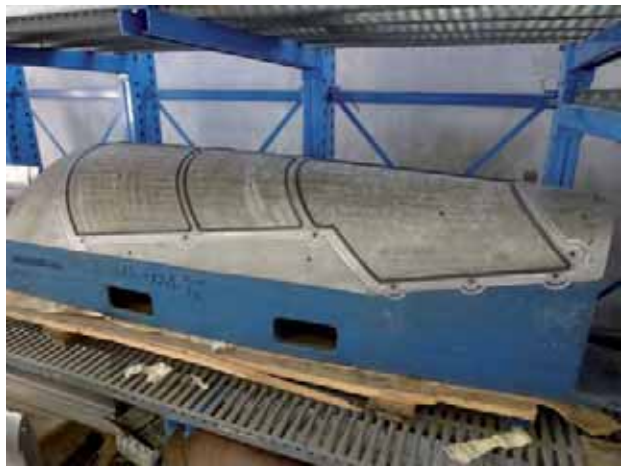
Rys. 1. Typowa forma mocująca stosowana w zakładach Piaggio Aero
