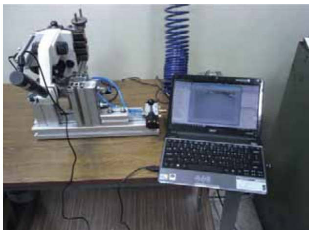
Rys. 21. Stanowisko pomiarowe służące wyznaczaniu przemieszczenia względnego elementów klejonych
