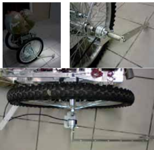
Rys. 15. Wychyłomierz, czyli urządzenie do pomiaru rzeczywistego kąta odchylenia od pionu Fig. 15. Inclinometer used to measure the real angle of inclination
