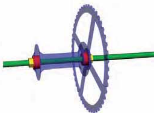
Rys. 3. Sposób zamontowania piasty koła na nieruchomej osi. Kolorem czerwonym zaznaczono łożyska
