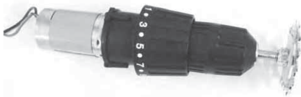
Rys. 7. Silnik HRS-550s z przekładnią planetarną i zębatką
