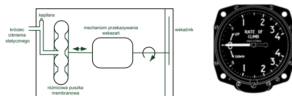
Rys. 6. Schemat funkcjonalny wariometru z kapilarą (z lewej) oraz widok wskaźnika (z prawej)
