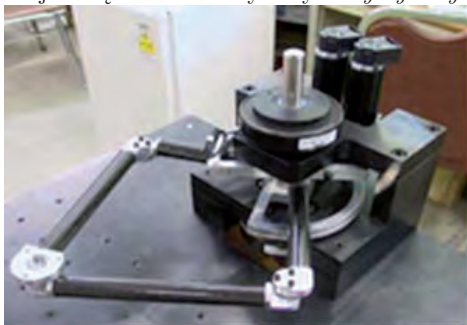
Rys. 6. Widok hybrydowego dżojstika MR [1] Fig. 6. MR hybrid joystick view
