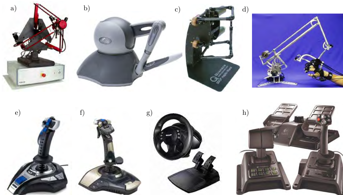
Rys. 5. Urządzenie Delta firmy Force Dimension [11] (a); PHANTOM Omni firmy SensAble [22] (b); Interfejs dotykowy HapticWand firmy Qanser [18] (c); FCS Operator Station [16] (d); dżojstik MetalStrike Force Feedback firmy Genius [12] (e); dżojstik Cyborg evo Force Feedback Saitek [21] (f); kierownica SideWinder Force Feedback firmy Microsoft [20] (g); Force-feedback Flight System G940 firmy Logitech [17] (h)
