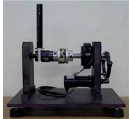
Rys. 7. Hybrydowy dżojstik dotykowy z cieczą MR [2, 3] Fig. 7. Hybrid haptic joystick with MR fluid
