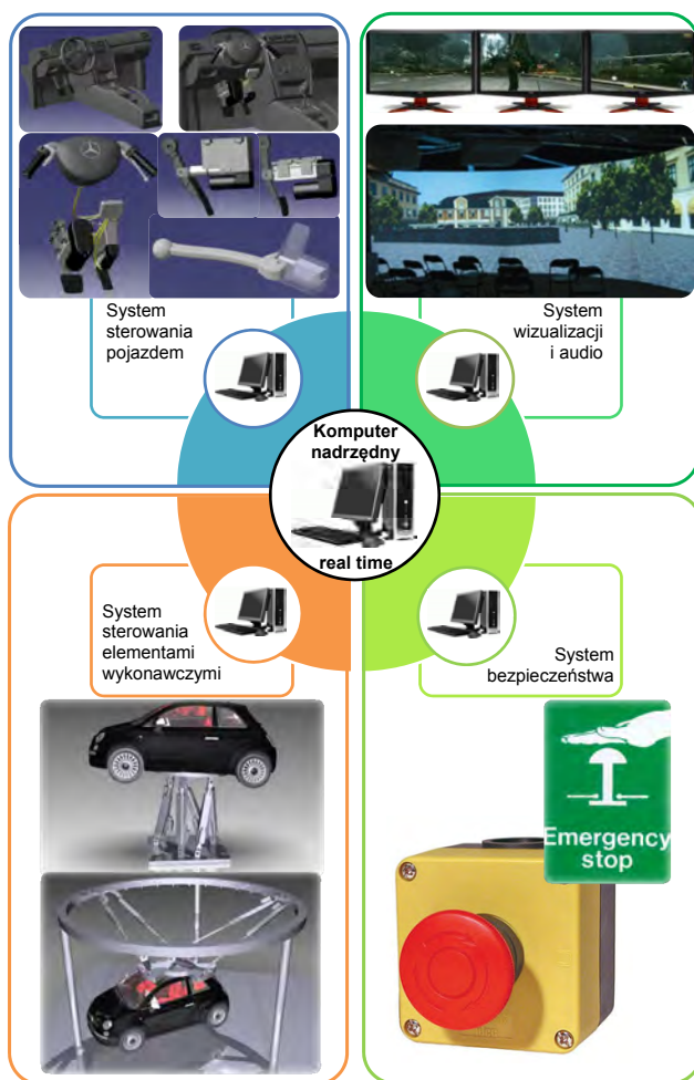
Rys. 1. Schemat struktury funkcjonalnej symulatora [2] Fig. 1. The functional structure's scheme of the simulator [2]
