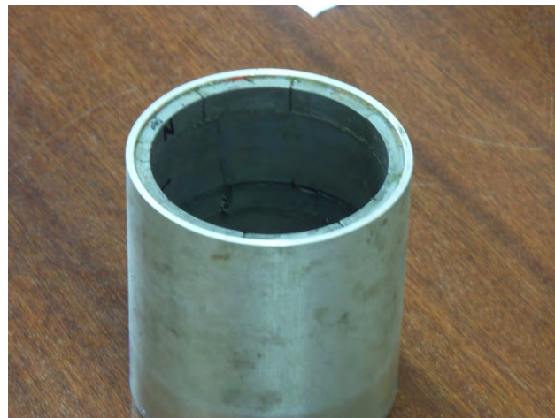
Rys. 11. Tablica Halbacha statora
