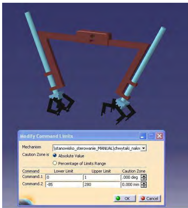
Rys. 4. Ustawianie ograniczeń ruchu dla chwytaka manipulatora Fig. 4. Setting the limits of motion for the manipulator gripper
