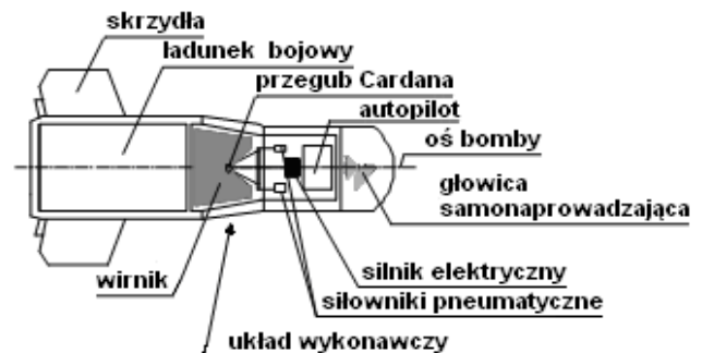
Rys. 1. Schemat ogólny elementów proponowanej bomby kierowanej
