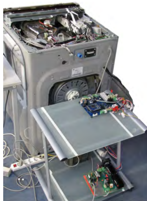
Rys. 5. Widok pralki z podłączonymi do niej sterownikami: głównym i dużej mocy (falownik)
