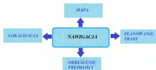
Rys. 2. Elementy systemu nawigacyjnego robota mobilnego Fig. 2. Parts of navigation system of a mobile robot
