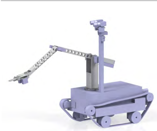
Rys. 2. Model brytowy robota mobilnego w systemie CATIA V5
