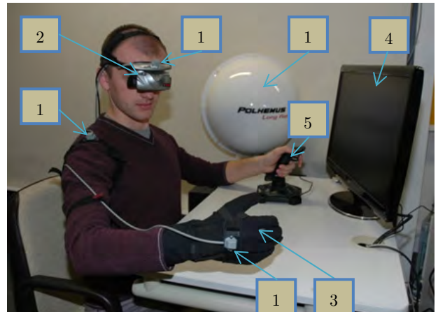
Rys. 7. Interfejs sterowania. 1 – magnetyczny system śledzenia, 2 – info-Hełm, 3 – info-rękawica, 4 – monitor 3D, 5 – joystick Fig. 7. Control interface. 1 – magnetic tracking system, 2 – HMD, 3 – data gloves, 4 – monitor 3D, 5 – joystick
