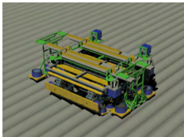
Rys.15. Piąta faza ruchu poprzecznego – złożenie ramy górnej
