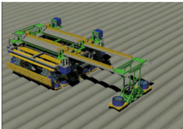
Rys.11. Pierwsza faza ruchu poprzecznego – wysunięcie górnej ramy
