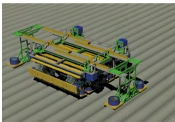
Rys. 13. Trzecia faza ruchu poprzecznego – przemieszczenie modułu głównego
