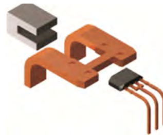
Rys. 9. Struktura wewnętrzna czujnika [2]
