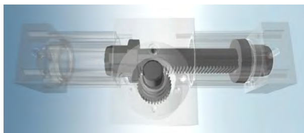
Rys. 20. Przykładowy model 3D siłownika obrotowego
