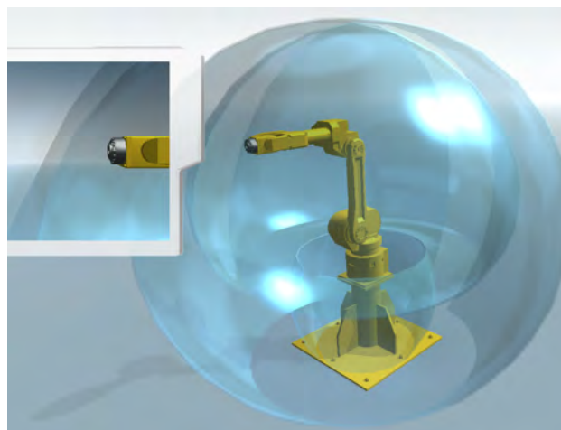
Rys. 3. Przestrzeń robota bez oprzyrządowania – slajd z przygotowanych prezentacji 3D
