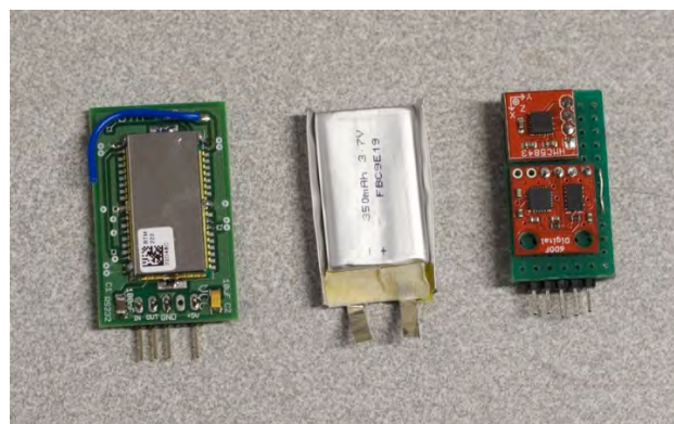
Rys. 4. Poszczególne elementy urządzenia do rejestracji rotacji (od lewej): moduł Bluetooth, bateria i moduł kontrolera z czujnikami
