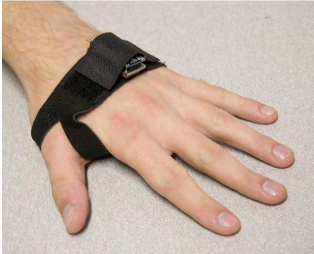
Rys. 5. Sposób zamocowania czujnika na rękę
