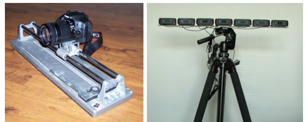
Rys. 2. Aparat fotograficzny Canon EOS 550D zamontowany na suwnicy (z lewej) oraz układ siedmiu kamer internetowych na statywie (z prawej)
