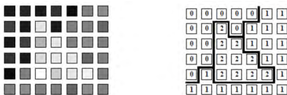
Rys. 5. Przykład przypisania etykiet pikselom na podstawie ich jasności. Grubą linią oddzielono grupy pikseli o takiej samej etykiecie
