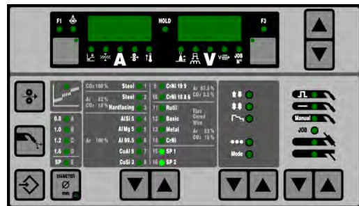
Rys. 5. Widok panelu spawarki prezentujący aktualne parametry pracy – Fronius Explorer
