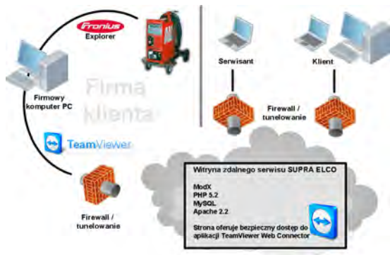
Rys. 4. Koncepcja systemu wykorzystującego oprogramowanie Team Viewer
