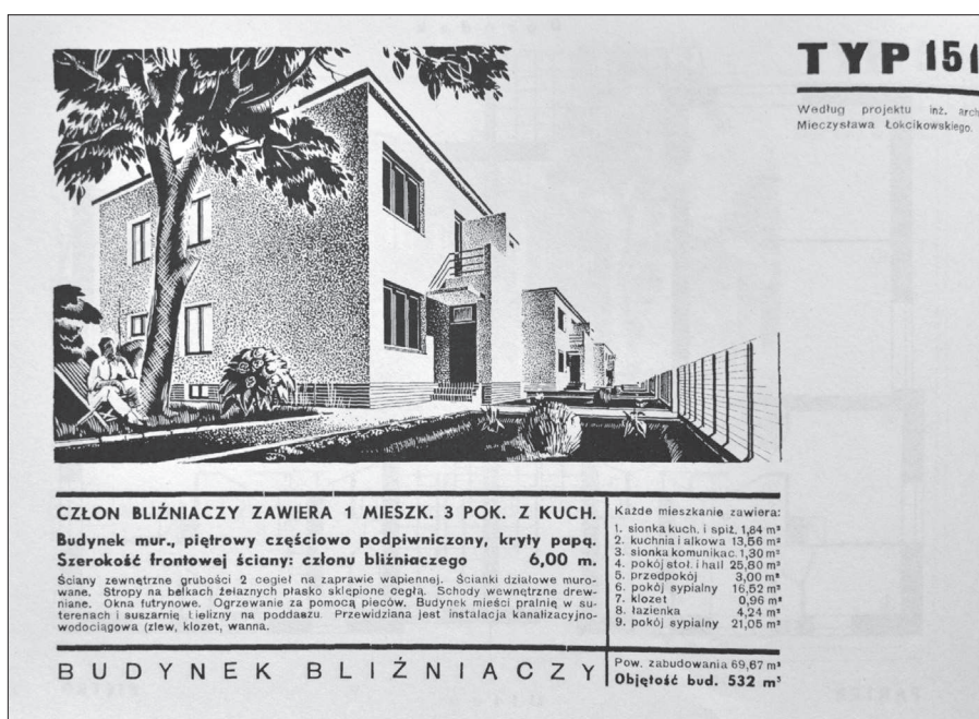
4. Strona Katalogu typowych domów dla drobnego budownictwa mieszkaniowego , projekt domu „typ 151” 4. A page from the Catalog of typical houses for small residential development , house „type 151” drawing, 1934
