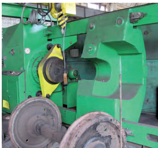
Rys. 1. Prasa o nacisku 6000 kN używana do wtlaczania zestawów kołowych
