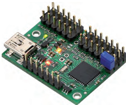
Fig. 13. Servo Controller Mini Maestro 12-Channel USB Servo Controller
