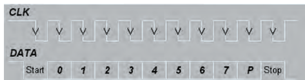
Rys. 3. Przebieg sygnałów przesyłania 8 bitów danych przez PS/2 Fig. 3. Transmission of 8 bits of data via PS/2
