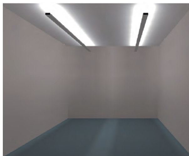
Rys. 8. Wizualizacja w programie Relux badanej instalacji oświetlenia pośredniego z diodami LED i przesłoną o szerokości 10 cm
