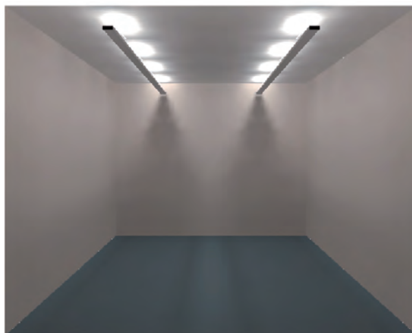
Rys. 2. Wizualizacja w programie Relux badanej instalacji oświetlenia pośredniego z przesłoną o szerokości 10 cm
