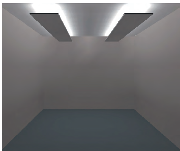
Rys. 10. Wizualizacja w programie Relux badanej instalacji oświetlenia pośredniego z diodami LED i przesłoną o szerokości 60 cm
