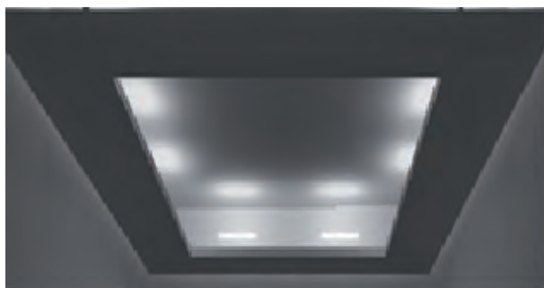
Rys. 13. Przykład wykonanej w programie Dialux wizualizacji instalacji oświetlenia pośredniego ze świetlówkami T5
