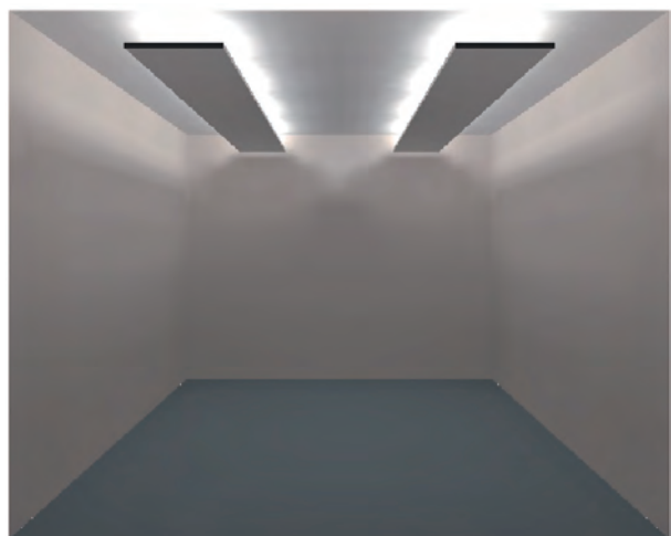
Rys. 4. Wizualizacja w programie Relux badanej instalacji oświetlenia pośredniego z przesłoną o szerokości 60 cm
