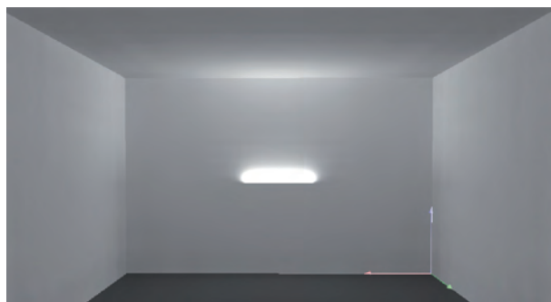
Rys. 16. Wizualizacja w programie Dialux sposobu świecenia 11 diod LED oddalonych od siebie o 10 cm i od ściany o 1 cm
