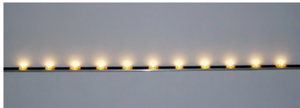
Rys. 15. Widok ściany oświetlonej diodami LED oddalonymi o 10 cm od siebie i o 1 cm od ściany
