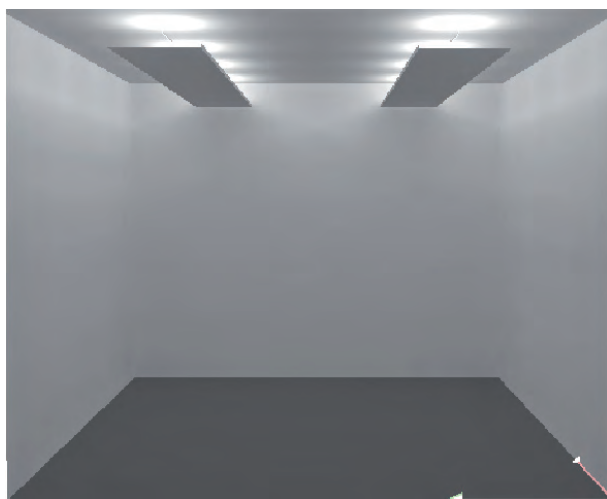
Rys. 3. Wizualizacja w programie Dialux badanej instalacji oświetlenia pośredniego z przesłoną o szerokości 60 cm
