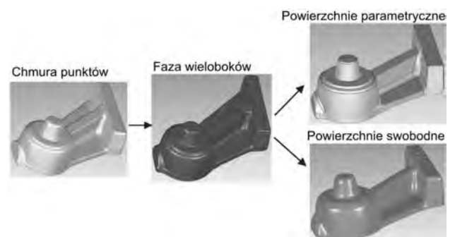
Rys. 5. Kolejne etapy przetwarzania wyników pomiarów w systemie Geomagic Studio 12
