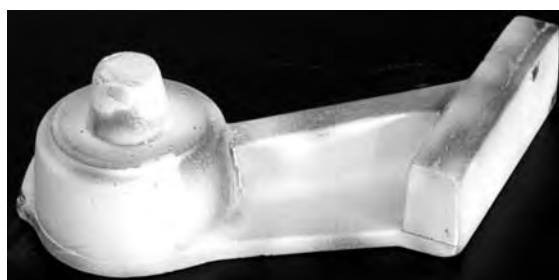
Rys. 2. Odtwarzany szablon odlewniczy Fig. 2. Reconstructed template casting
